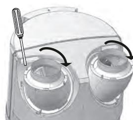
③ Monter les raccords pour gaines en effectuant un mouvement de 1/4 de tour dans le sens horaire et revisser.
